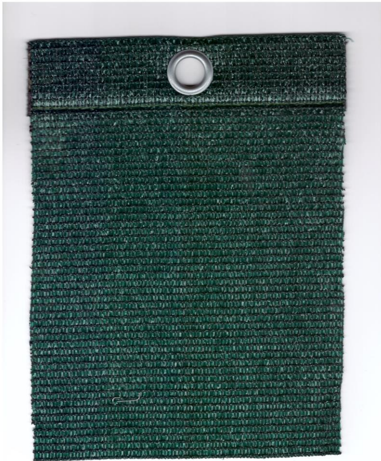
Bild 6: Untersuchtes Kunststoffgewebe, Lieferant Fa. evia Verkehrstechnik GmbH/ACCURA NTV KG Maßstab: ca. 1:2
