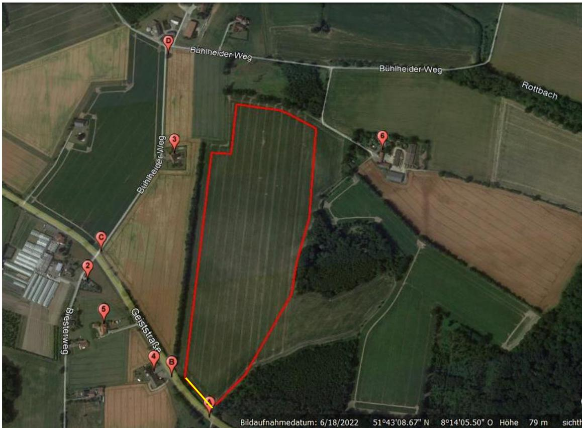
*Bild 1: Übersicht der geplanten PV-Anlage Wadersloh 2 mit den untersuchten Blickpunkte A bis D auf der Geiststraße/dem Bühheider Weg und den Immissionsorten 2 bis 6*
